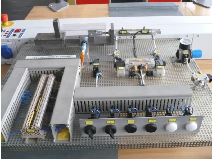
Abb.: Pneumatisch betriebene Kugelsortiermaschine
